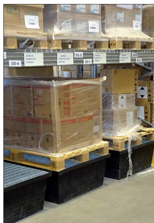
Matériel stocké sur rétention
