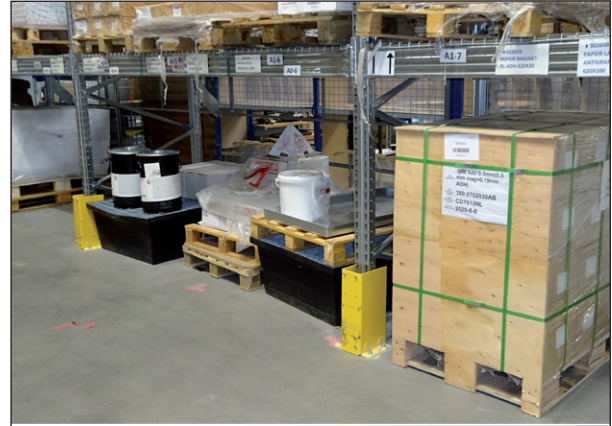
Décollement du sol par palettes de l'ensemble du matériel.
