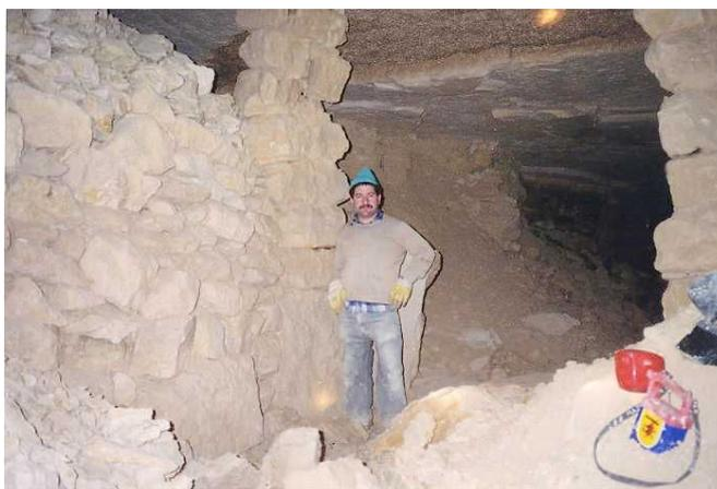
**Figure 5 : Une galerie dans une carrière exploitée par hagues et bourrages**
