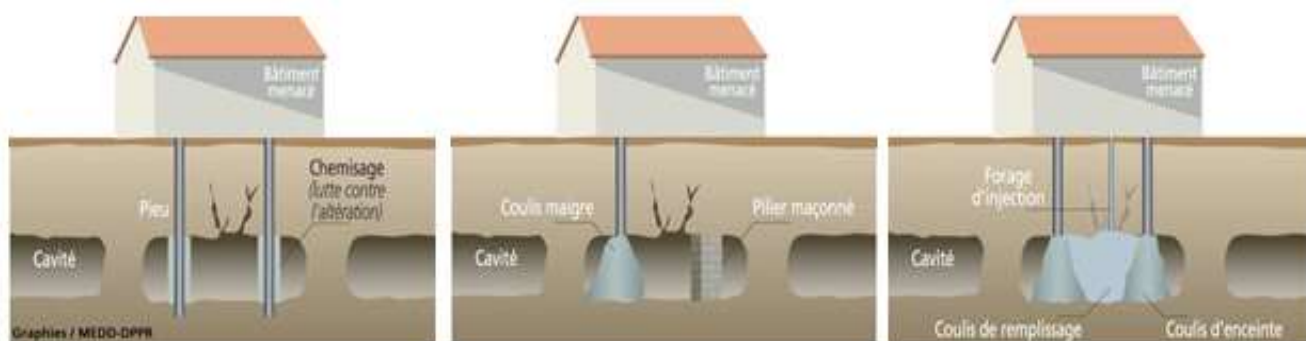
Fig. 34 : Protection active contre les cavités souterraines.
